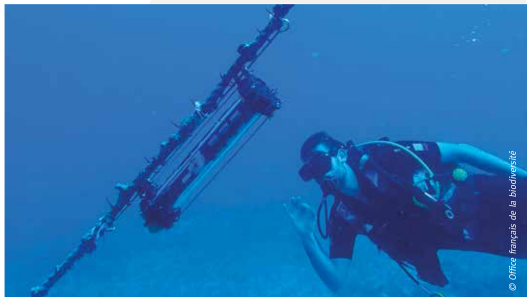
Pose d'un hydrophone lors de la phase test en 2019 à Saint-Barthélemy.
